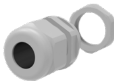
Accessoires Presse-étoupe M20 (Plage de serrage : 7,0 à 12,0 mm)
