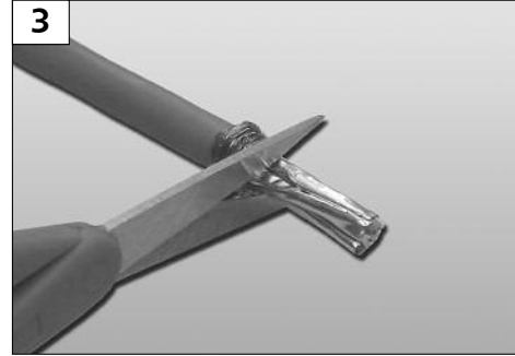
3 Paar-Schirmfolie einkerben und entfernen. Cut and remove the shield foil of the wire pairs.
